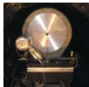
図3 高分解能2次元検出器（シンチレータ&2次元光電子増倍管）背面に見えるのが従来のヘリウム検出器
