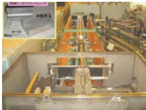
図2 中性子集光レンズ（フッ化マグネシウム）と非磁性コリメータ
